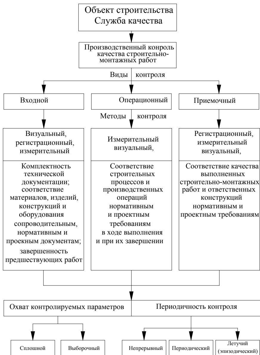
Рисунок 1 - Общая схема производственного контроля качества строительно-монтажных работ.
