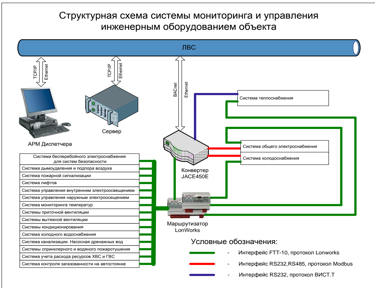
Рис 1. Структурная схема системы мониторинга и управления инженерным оборудованием объекта
