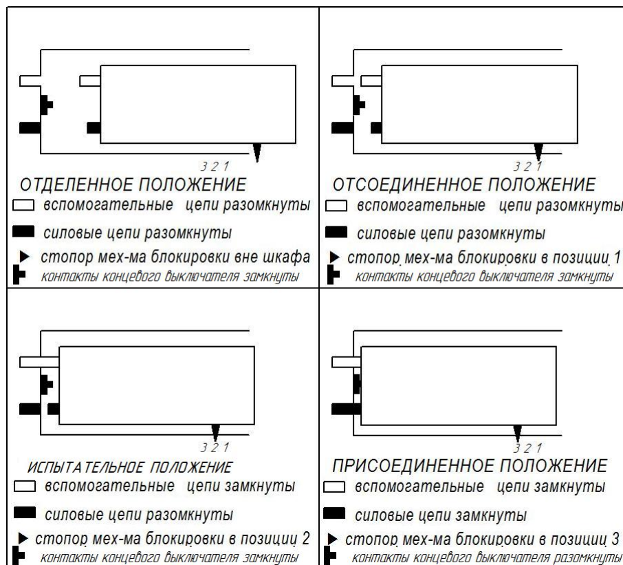
Рисунок 5.14 – Положения выдвижных блоков
