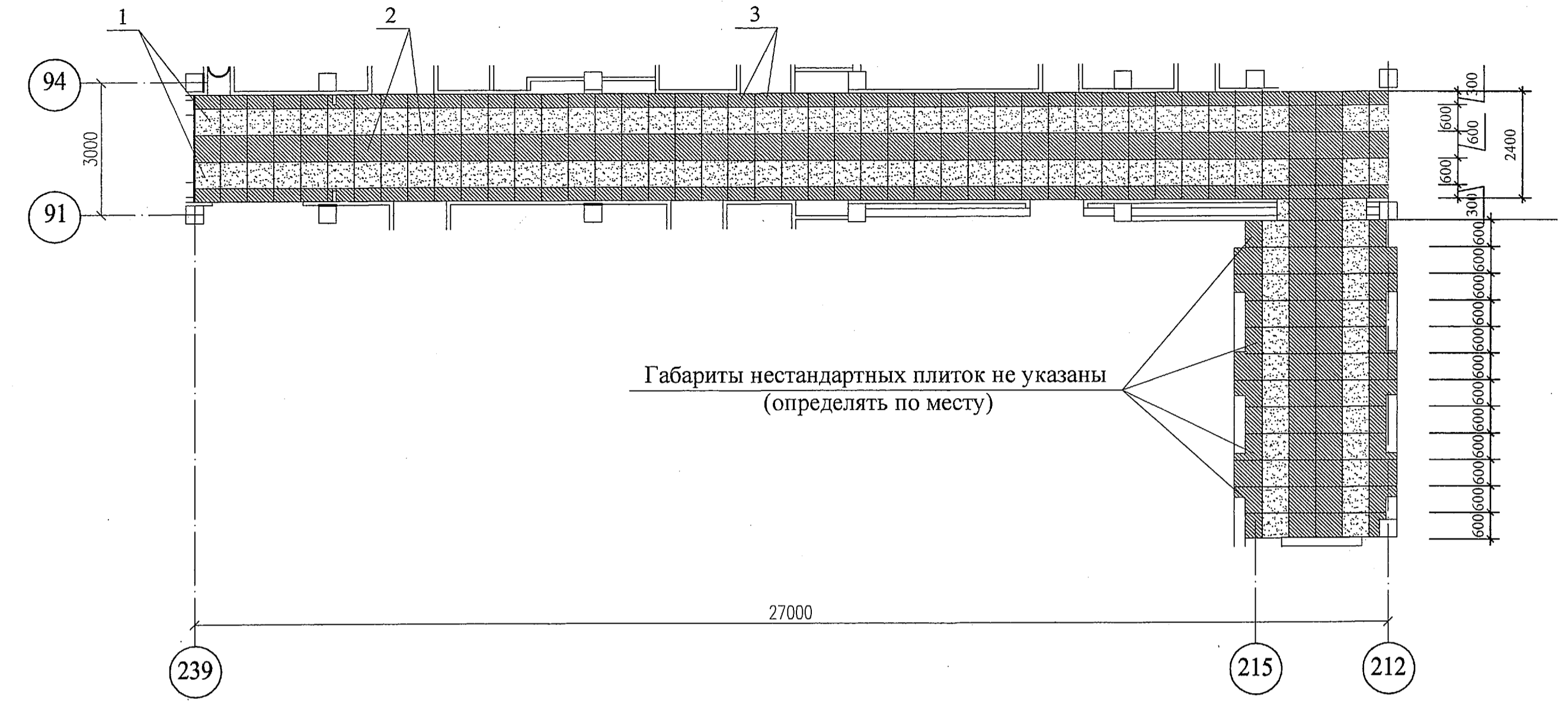
Схема раскладки керамогранитных плиток пола в коридоре на отм.+9,950 (3 этаж)
