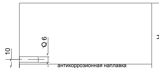
Рис.3 СОП для настройки ПЭП «корневой тандем».
