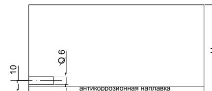
Рис.3 СОП для настройки ПЭП «корневой тандем».
