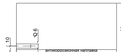
Рис.3 СОП для настройки ПЭП «корневой тандем».
