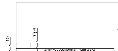
Рис.3 СОП для настройки ПЭП «корневой тандем».
