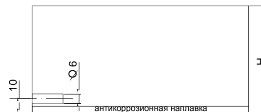
Рис.3 СОП для настройки ПЭП «корневой тандем».
