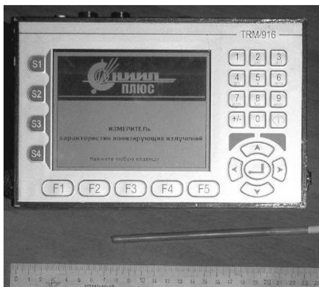
Рисунок 9 - Внешний вид блока управления МКС-21П и блока детектирования гамма-излучения БДРС-07П
